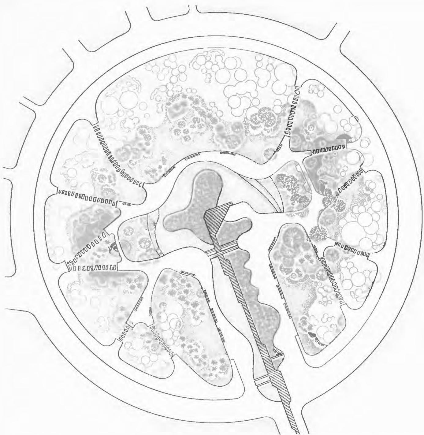
чертеж, на котором изображен объект в проектируемых границах (рис. 192). На чертеже показаны существующие и проектируемые насаждения с обозначением типа посадок (деревья, кустарники, цветочные и травянистые), открытые газонные пространства, водоемы, дорожно-тропиночная сеть, площадки, малые формы, сооружения, входы; на плане указывают ширину основных дорог, габариты площадок, зданий, горизонтали рельефа. На полях чертежа приводят экспликацию, условные обозначения, ориентацию по стра-
